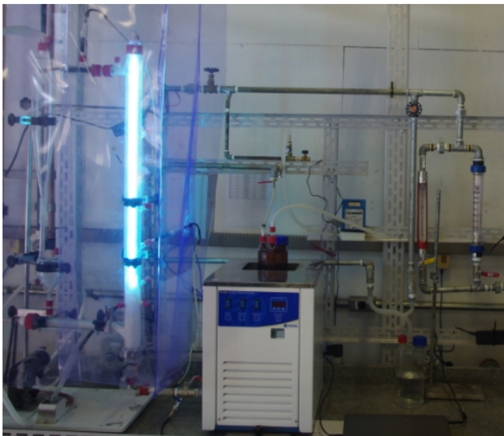
Figura 5: Fotografia do reator e sua unidade de contaminação do ar e direcionamento ao reator fotocatalítico de leito fluidizado.
